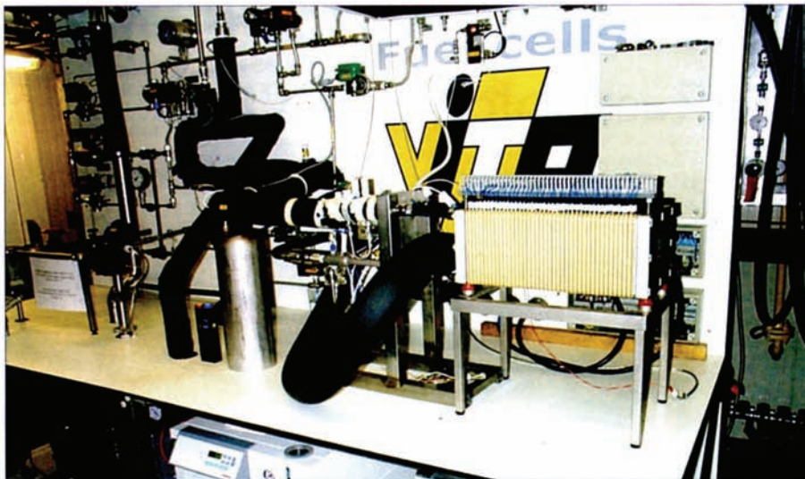
Figuur 2. Test van een brandstofcel met een vermogen van 6 kW.
